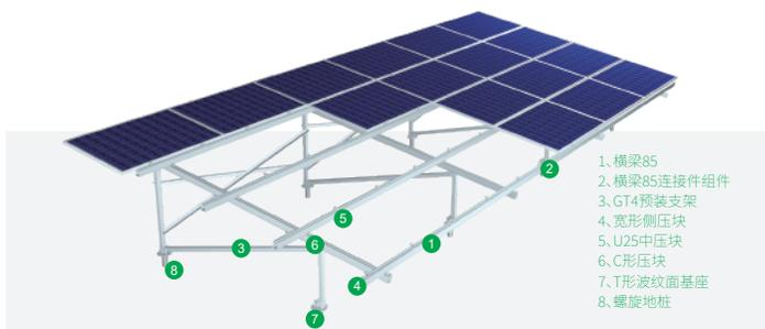
MRac地面光伏支架系统GT4 该产品适用于中大型光伏电站的安装，具有高度预安装特性，适用于抗风雪能力要求更高的安装区域，支架系统可前后、左右及上下方向调节，专业的结构设计在确保系统强度的前提下，有效的提高了工程安装的时效，大大降低了安装成本。
